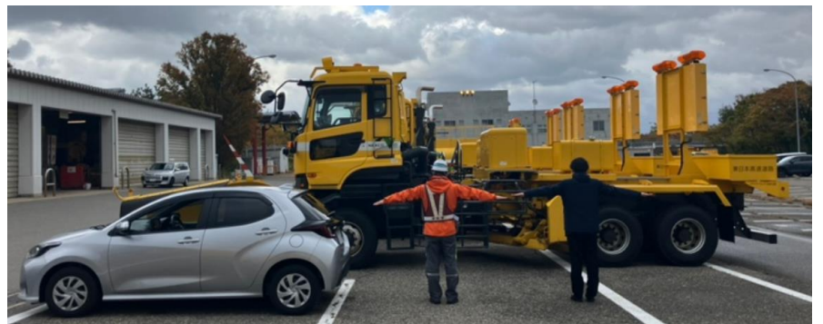
手前側乗用車は全長約3.9m、奥側除雪車両はスノープラウを含め全長約12m
